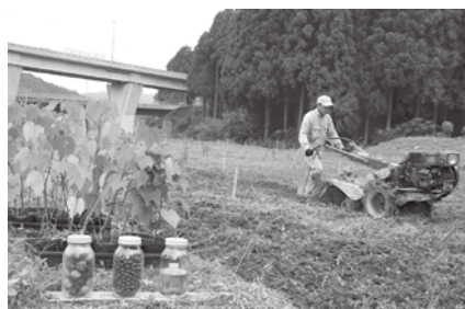
アブラギリ油(手前瓶液体)での試運転
